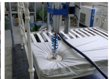
ベッドの垂直荷重試験
