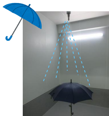
傘の耐漏水性試験
