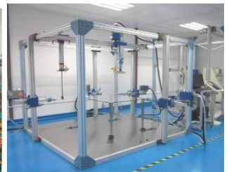
家具総合強度試験機 (机、ベッド、いす、収納家具)
